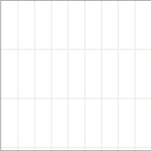
(P4) - KERAMICKÝ OBKLAD - REF. VÝR. COLOR SYSTEM BLANCO MAT - ROZMĚR: 10x30cm, TL. 0,8cm - BARVA: BÍLÁ - EPOXIDOVÁ SPÁROVACÍ HMOTA V ODSTÍNU DLAŽBY(SVĚTLE BÉŽOVÁ)
